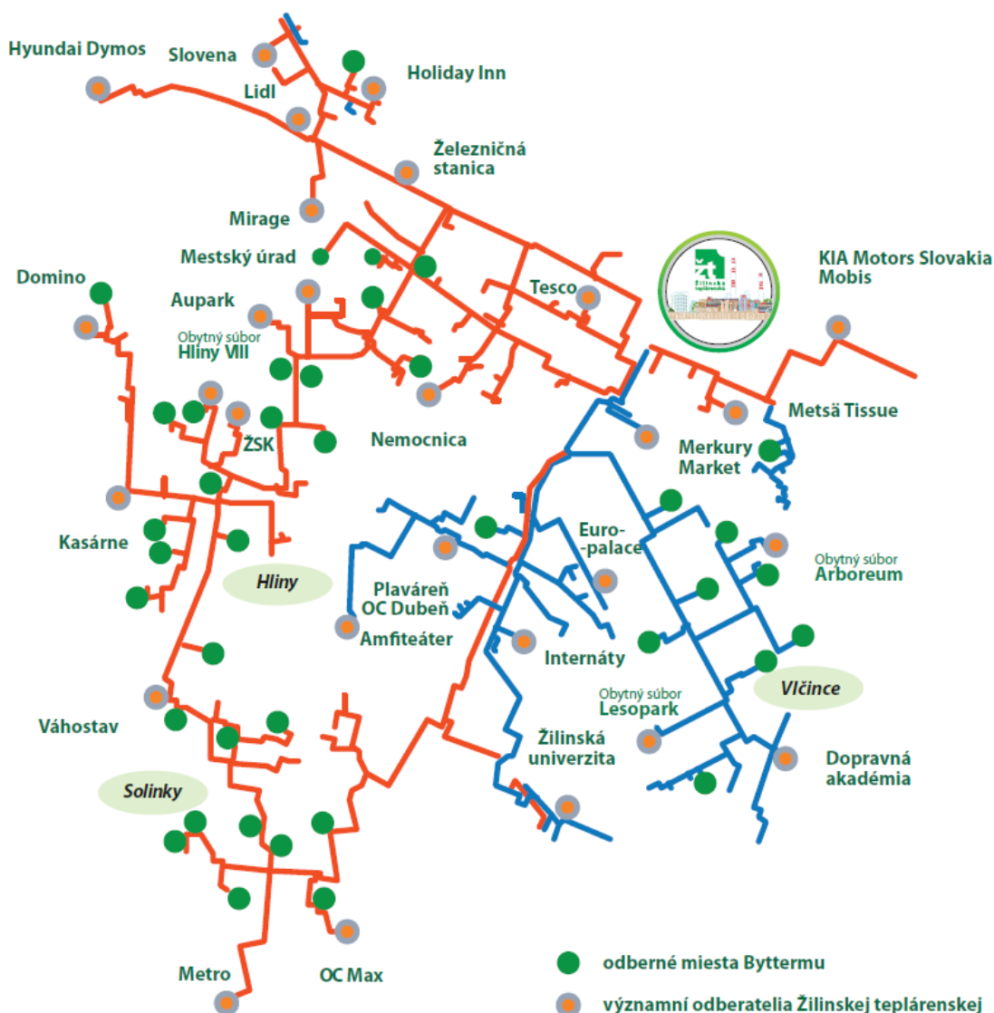
Obr. 14 Primárne parné a horúcovodné tepelné siete SCZT, Ž. T., a.s., Žilina (Zdroj: Ž. T. a.s.)
